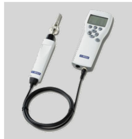
Компактный измеритель точки росы Vaisala DRYCAP® DM70 наилучшее средство проверки рабочих характеристик трансмиттера DMT242 на местах.
